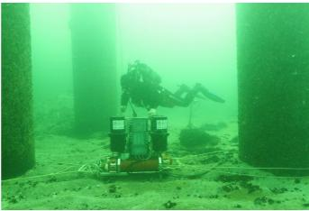
Der Prototyp des Unterwasser-Brennstoffzellensystems wurde 8 Wochen lang erfolgreich in der Ostsee nahe der Deutschen Küste zum Nachweis des Funktionsprinzips im Seewasser getestet. Zu diesem Zweck wurde ein System mit kleiner Leistung und geringen Mengen an Brennstoff und Oxidanz ausgewählt. Gegenwärtig erfolgen Produktanpassungen wie z.B. Elektrodenvergrößerung und Brennstoffauswahl.
