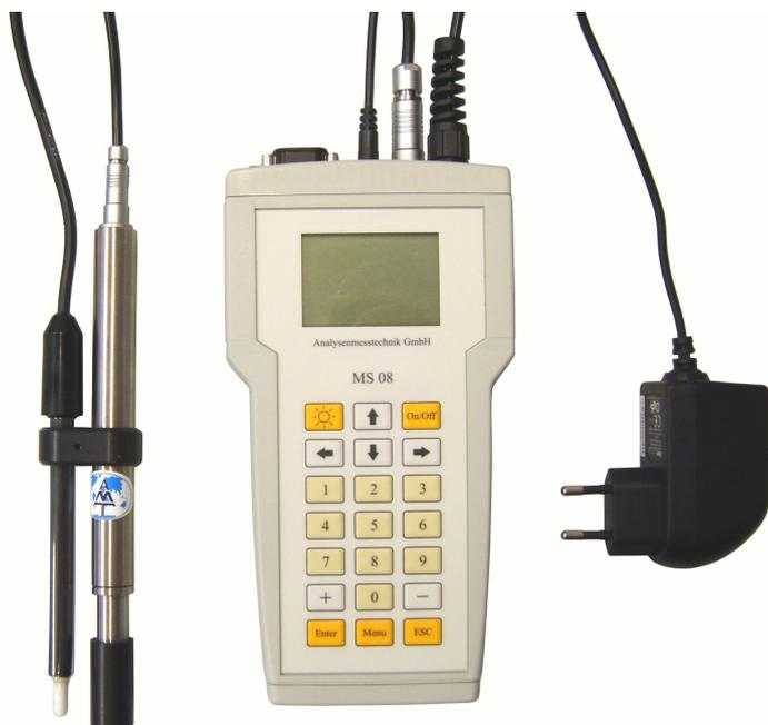
Das mikroprozessorgesteuerte Meßgerät ist für die schnelle und genaue Bestimmung von in Wasser gelöstem Ozon entwickelt worden. Es ist sowohl für den Laborbetrieb als auch für den einfachen Feldeinsatz geeignet. Das Gerät ist mit einem anströmungsfreien, membranbedeckten, amperometrischen Ozon-Mikrosensor und einem Temperaturfühler ausgestattet. Es zeigt auf dem Display die Konzentration des Ozon in mg/l sowie die Temperatur der Probe an.
