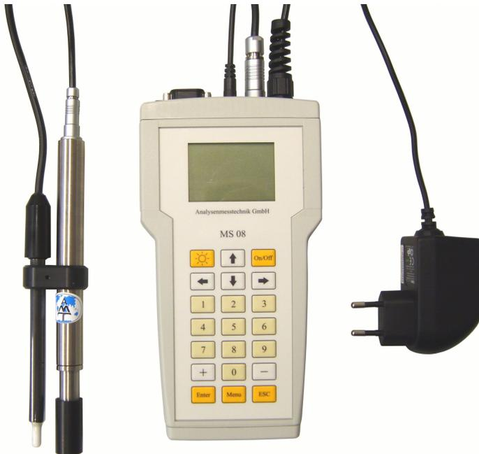
Das mikroprozessorgesteuerte Messgerät ist für die schnelle und genaue Bestimmung von in Wasser gelöstem Wasserstoff entwickelt worden. Es ist sowohl für den Laborbetrieb als auch für den einfachen Feldeinsatz geeignet. Das Gerät ist mit einem anströmungsfreien, membranbedeckten, amperometrischen Wasserstoff-Mikrosensor und einem Temperaturfühler ausgestattet. Es zeigt auf dem Display die Konzentration des Wasserstoffs in mg/l sowie die Temperatur der Probe an.
